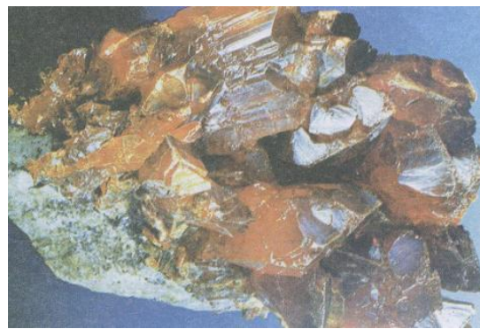
Σφαλερίτης. Ορυκτό από το οποίο παράγεται το μέταλλο ψευδάργυρος. Υπάρχει στη Θάσο και στη Χαλκιδική.
